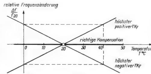
Bild 3. Kompensation bei temperaturunabhängigem TK<sub>f</sub>
