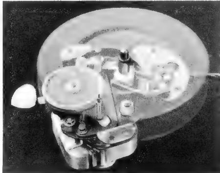
Lorenz-Plattenspielerantrieb. Durch einen Fototrick ist der Plattenteller durchscheinend mit abgebildet.
