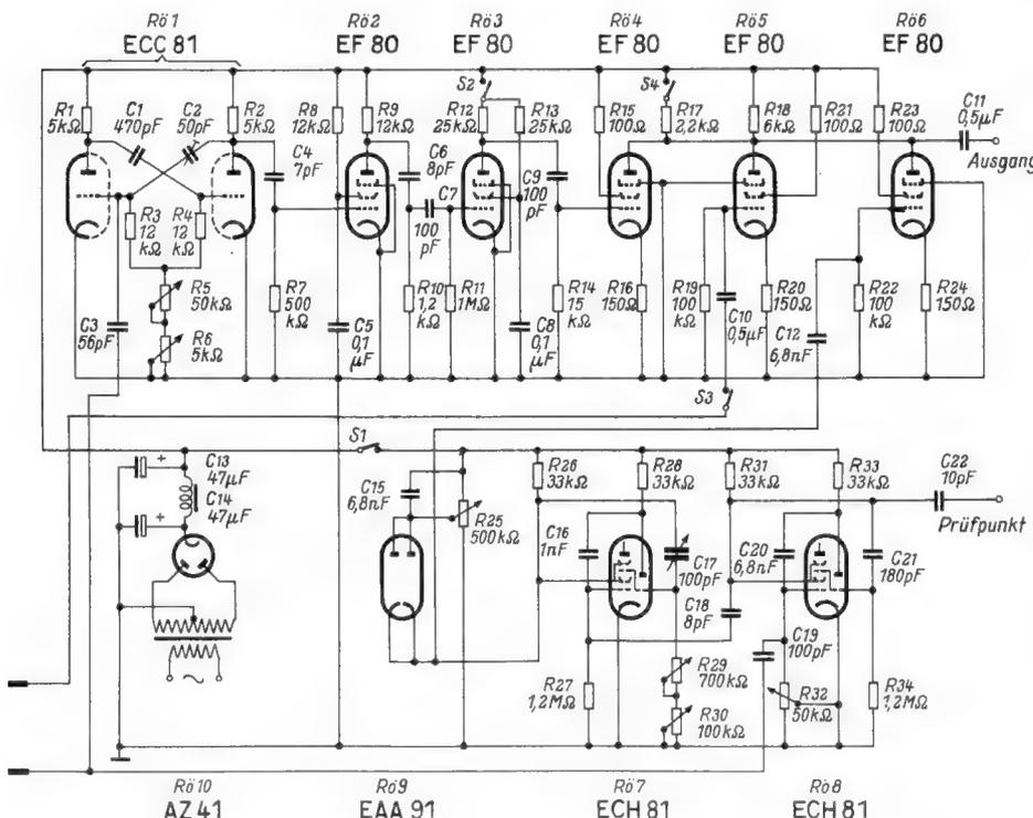
Bild 6. Gesamtschaltung eines Prüfgerätes zum Erzeugen von Punktrastern auf dem Fernseh-Bildschirm
