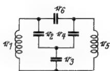
Bild 2. Anwendungsfall einer überbrückten T-Schaltung; Bandfilter mit Fuß- und Kopfkopplung
