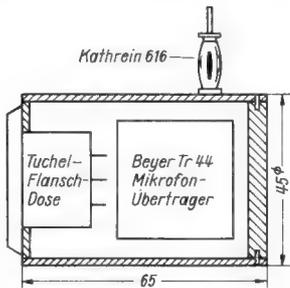
Bild 1. Aufbau des Steckübertragers
