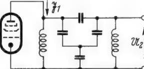
Bild 2a. Das Bandfilter nach Bild 2 wird von einer Röhre gespeist
