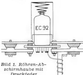
Bild 1. Röhren-Abschirmhaube mit Druckfeder
