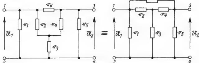
Bild 1. Überbrückte T-Schaltung
