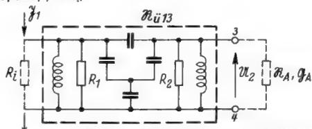
Bild 2b. Vollständiges Ersatzbild für Bild 2 mit angekoppelter Röhre und Berücksichtigung der Spulendämpfung
