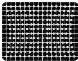
Bild 2. Kissenförmige Verzerrung
