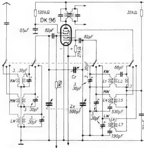
Bild 1. Schaltung eines AM-Oszillators mit der Batterieröhre DK 96. Der Trimmer C<sub>T</sub> und die Spule L 3 bewirken gutes Durchschwingen im KW-Bereich
