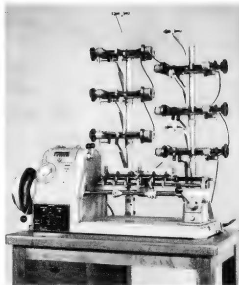
Feindrahtwickelmaschine zum gleichzeitigen Wickeln von sechs Spulen (Friesseke & Hoepfner)
