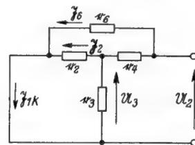
Bild 3b. Ermittlung von  $Y_2$  aus  $I_{1K}$  und  $U_2$
