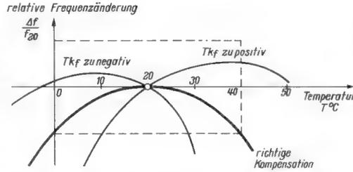
Bild 2. Kompensation bei temperaturabhängigem TK<sub>f</sub>
