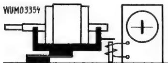
Schallplatten - Antriebs - Motoren müssen frei von Erschütterungen laufen, sonst nimmt der Tonabnehmer diese auf und der Ton wird verzerrt. Wichtig ist, daß der Läufer des Motors gut „ausgewuchtet“ wird. Man versteht darunter das Beseitigen von Schwerpunktsverlagerungen, wie sie durch kleine
