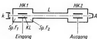
Bild 26. Hahn-Metcalf Röhre. HK 1, HK = Heilsche Kammern, L = Laufraum zwischen beiden Kammern, Sp.F1, Sp.F2 = Spaltfeld 1 und 2 in jeder Kammer, KL = Laufkammer innerhalb einer Heilschen Kammer
