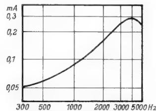
Bild 6. Nf-Kopfstrom bei  $U_E = 50 \mu V$
