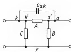
Bild 5. Umformung der T-Schaltung nach Bild 4 in eine  $\Delta$ -Schaltung
