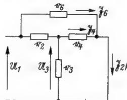
Bild 3c. Berechnung von  $Y_3$  für Kurzschluß an 3, 4 aus  $I_{2K}$  und  $U_1$
