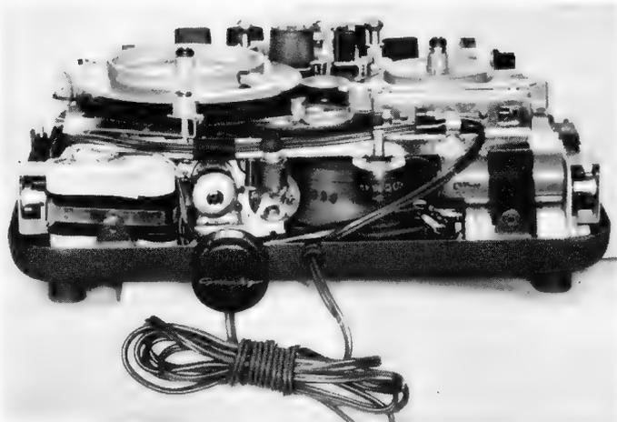
Bild 4. Rückansicht der geöffneten Stenorette
