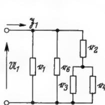
Bild 3a. Zur Bestimmung von  $Y_1$  sind die Klemmen 3, 4 aus Bild 1 kurzgeschlossen
