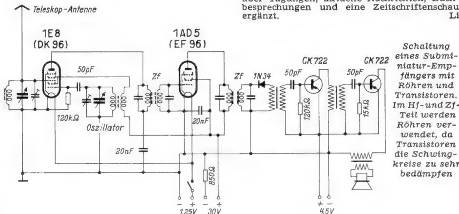
Schaltung eines Subminiatur-Empfängers mit Röhren und Transistoren. Im Hf- und Zf-Teil werden Röhren verwendet, da Transistoren die Schwingkreise zu sehr bedämpfen
