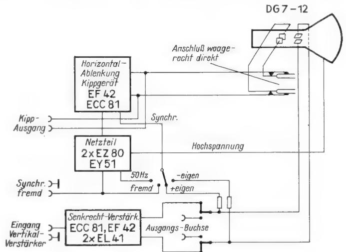
**Bild 1.** Blockschaltung des Nordmende Fernseh-Oszillografen FO 959
