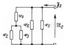
Bild 3d. Bestimmung von  $Y_4$ . Klemmen 1, 2 kurzgeschlossen
