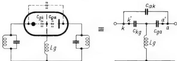
Bild 4. Gitterbasis-Schaltung mit Induktivität in der Gitterleitung
