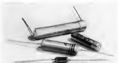
Verschiedene Ausführungen von Resistiv-Widerständen. Rechts ein kappenloser Spezialwiderstand für Höchstfrequenzen, davor ein tropfenfester Widerstand mit Farbringkennzeichnung, ganz vorne ein 0,5-W-Schichtwiderstand mit axialen Anschlußdrähten und dadurch sehr geringen Abmessungen
