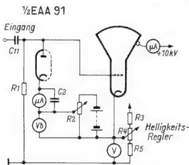
Bild 5. Zusatzschaltung zum Messen des Strahlstromes
